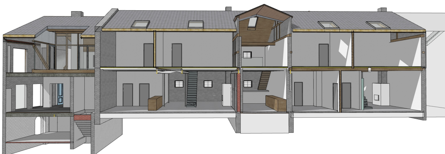
Längsschnitt Anbau & Stallspeicher, Blick von Süden
